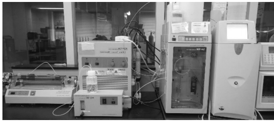
図1 燃焼イオンクロマトグラフィーの外観
